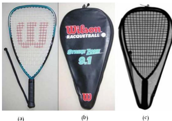
شکل (۲-۴): (a) تصویری از راکت تنیس (b) تصویر راکت در یک پاکت پلاستیکی (c) تصویر موج تراهرتز (۰/۶ تراهرتز) از راکتی که در پاکت پلاستیکی قرار دارد [۲۲].
