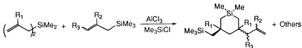
شکل (12-1): واکنش دی‌آلیل سیلان‌ها و آلیل تری‌متیل سیلان‌ها در مجاورت آلومینیوم کلرید
