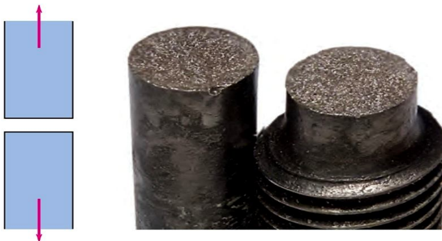
شکل 1-3: سطح مقطع شکست مواد ترد.
