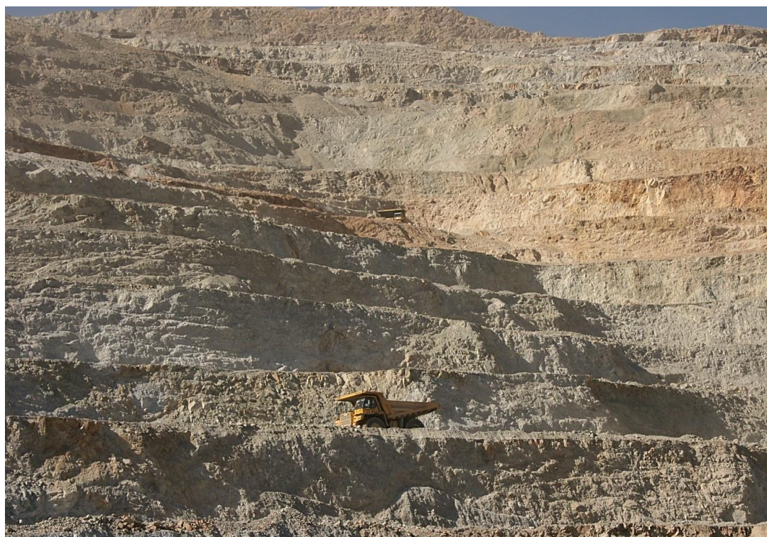
شکل (۱-۲): پله های استخراجی معدن مس سونگون و عملیات استخراجی در آنها
