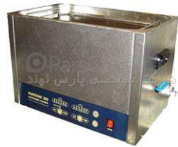
شکل (۳-۱): حمام فراصوت برای استفاده در صوت شیمی
