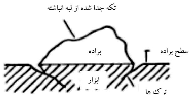
شکل ۱-۱۲ ایجاد ترک در سطح ابزار در اثر تفاوت در ضریب انبساط حرارتی ابزار الماسه و لبه انباشته [۵].
