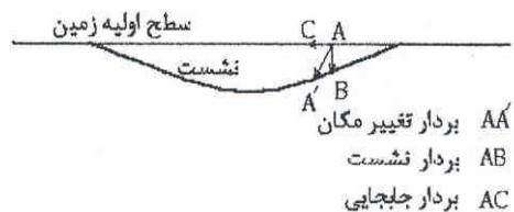
شکل (۲-۱): مولفه های قائم و افقی تغییر مکان یک نقطه از سطح زمین در فرآیند نشست
