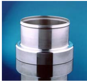
شکل (۴-۱) نمونه از قطعه پله ای شکل داده شده با روش اسپینینگ [2]
