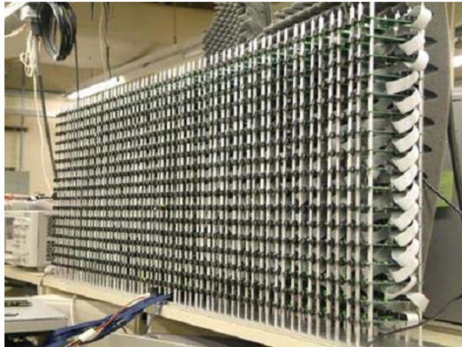
شکل ۹: سیستم ۱۰۲۰ میکروفون دانشگاه MIT [۲۶]
