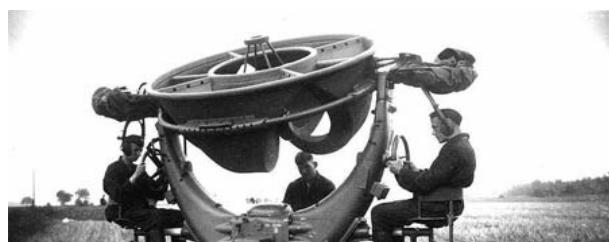
شکل ۵: سیستم آلمانی گیرنده با چهار سنسور دو درجه آزادی، با قابلیت مکانیابی تا فاصله ی ۱۲ کیلومتر (۱۹۴۰) [۳۴]
