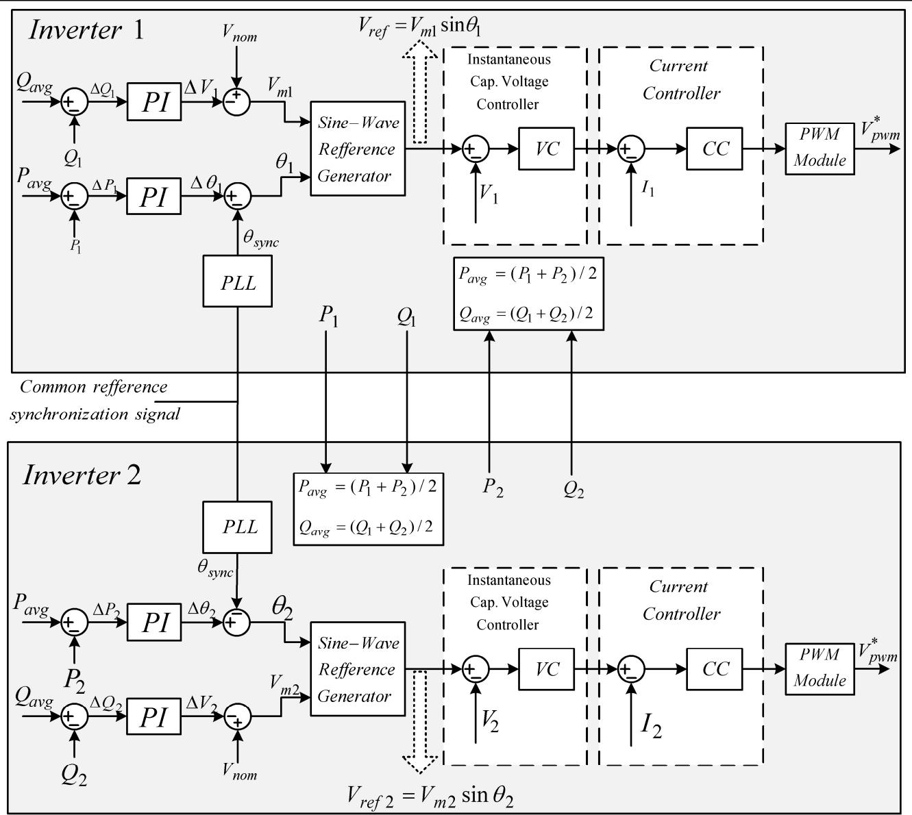
شکل ۱-۵: روش کنترلی اختلاف از مقدار متوسط توان
