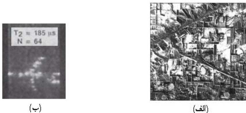
شکل ۲-۰: الف- تصویر گرفته شده از سطح زمین توسط SAR ب- تصویر ISAR هواپیمای ۷۲۷ [6]
