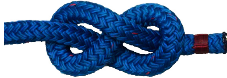
شکل ۲.۱: ساخت گره هشت لاتین با طناب.
