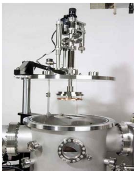
شکل (۱-۳): مراحل لایه‌نشانی به شیوه تبخیر فیزیکی
