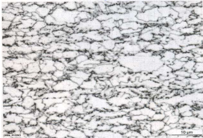
شکل ۲-۲. ساختار داخلی فولاد دوفازی فریتی- بینیتی (ناحیه سفید فریت و ناحیه تیره بینیت است) [۲۴].
