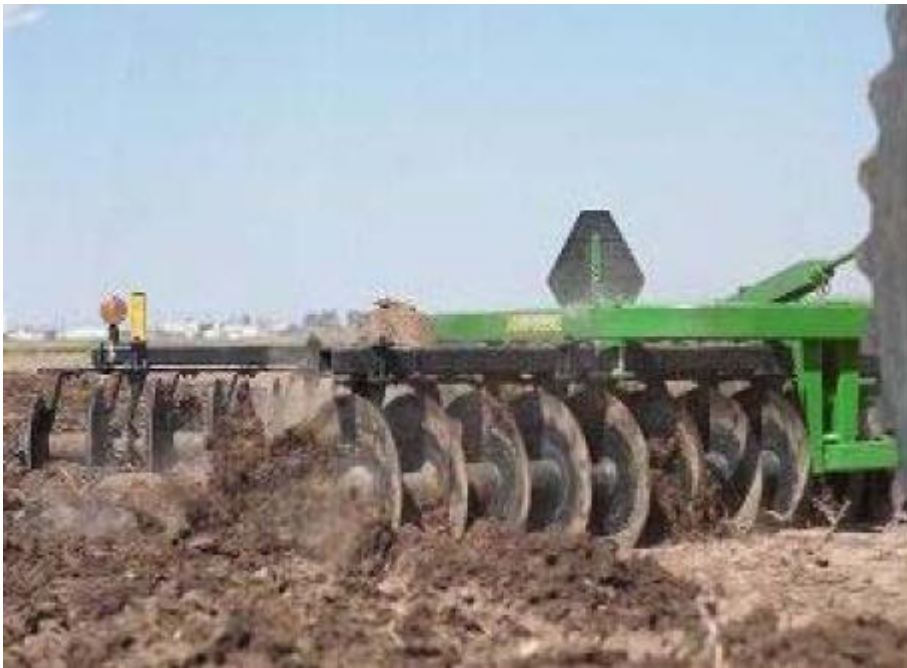
شکل 1-2- دیسک خاکورزی اولیه در حال خاکورزی در زمین شخم نخورده (بی نام، 2007)
