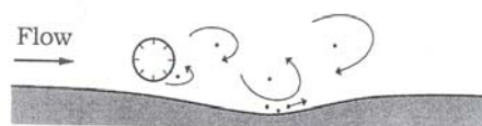
شکل ۱۰: جابه جایی ذرات رسوب بستر ناشی از گردابه فکنی در پشت لوله، (Sumer و همکاران، ۱۹۸۸)
