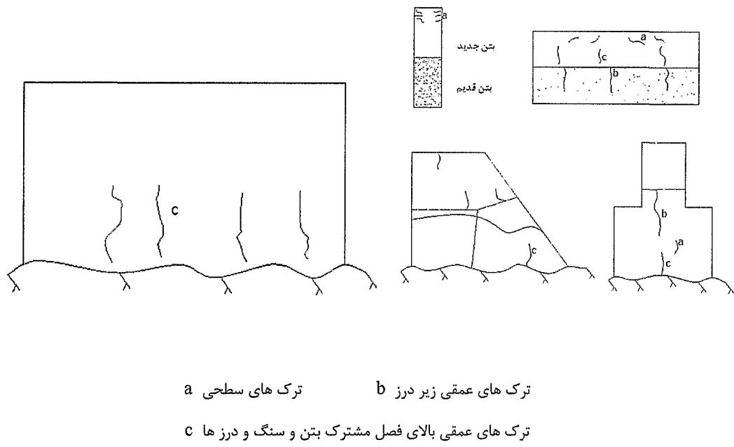
شکل ۱-۱ ترک های ناشی از تنش های حرارتی
