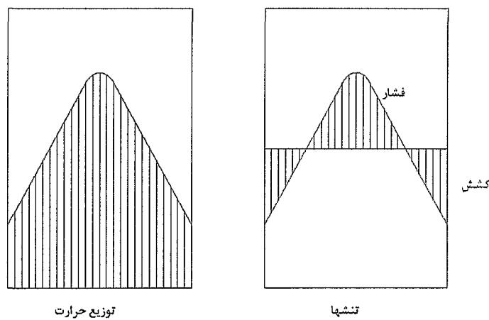
شکل ۲-۱ تنشهای حرارتی در مقطع بتونی با توجه به گرادیان حرارتی
