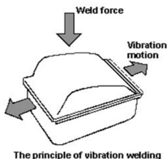
شکل ۳-۱ تصویر شماتیک جوشکاری ارتعاشی (تراوتن، ۲۰۰۵) ۳
