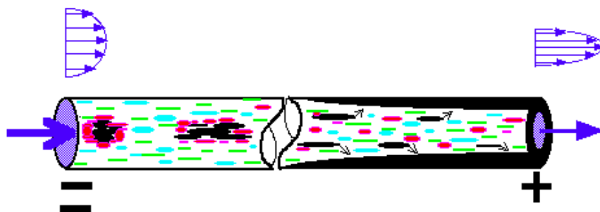
شکل ۱-۲ رسوب دهی و بسته شدن یک خط لوله به علت تشکیل رسوب آسفالتین
