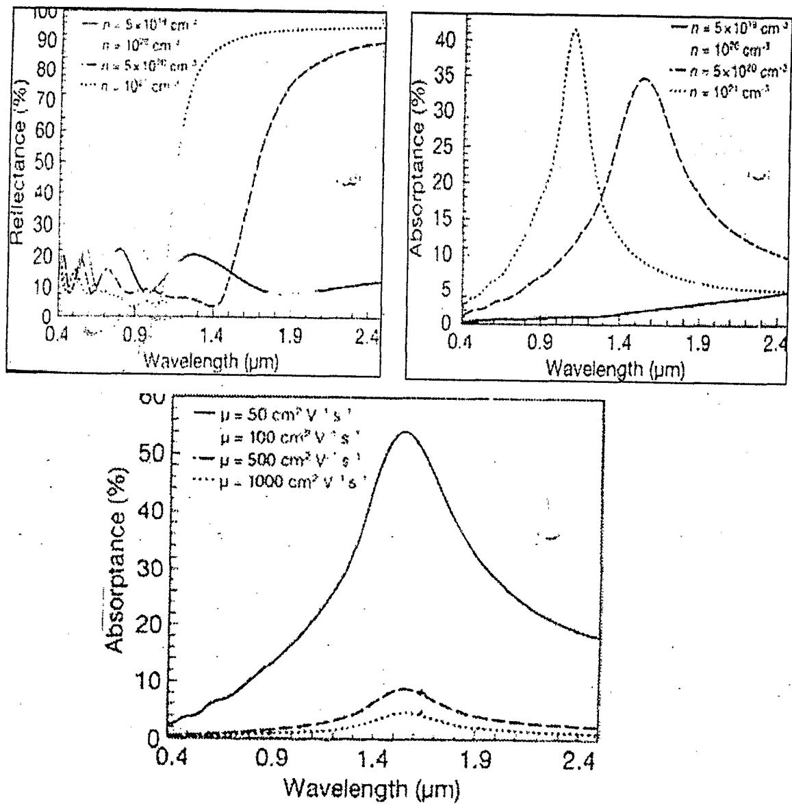
شکل(۱-۱) الف: منحنی بازتاب اکسید هادی شفاف و وابستگی آن به میزان تمرکز حامل ها
