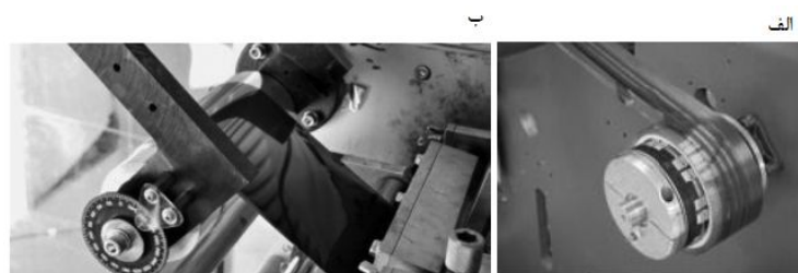
شکل ۱-۲: الف) تولید غلتهای پلیستیک فوتوولتائیک. ب) چاپ جوهر نیمرسانای CIGS روی ورق آلومینیوم [۱].
