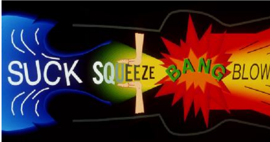
شکل (۱-۱). تئوری کلی موتورهای توربینی احتراقی
