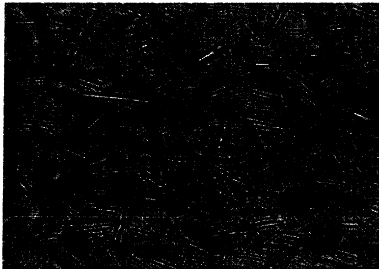
تصویر ۱-۱: الیاف آلومینا با بزرگنمایی 400X
