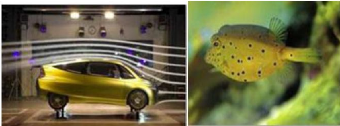
شکل 1-1: طراحی خودروی بیو ممتیک با الهام از شکل ماهی جعبه‌ای
