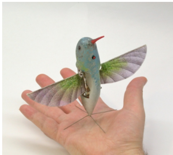
شکل (۴-۱): روبات مرغ مگسخور آ.کی.آ، یکی از موفق ترین وسایل پرنده کوچک (لنز دوربین کار گذاشته شده در این روبات در قسمت جلویی آن قابل مشاهده است).
