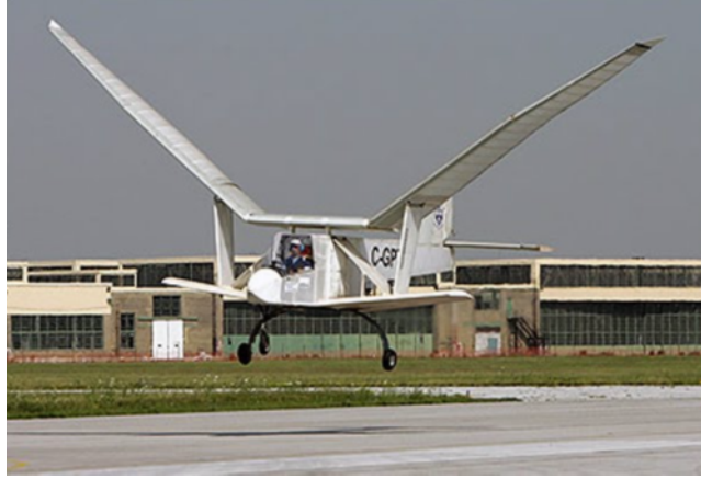
شکل (۲-۱): UTIAS Ornithopter No. ۱ ساخته دانشگاه تورونتو سال ۲۰۰۶، که ۳۰۰ متر پرواز کرد.
