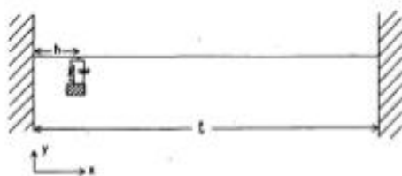
شکل 2-1: مدل آلنوت برای خط هوایی انتقال و دمپر [5].
