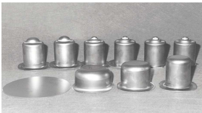
شکل ۲-۱: مراحل تولید پوسته‌ی موتور به روش کشش عمیق که در طی ۹ مرحله تکمیل شده است [۲].
