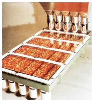
شکل (۱-۹) : دستگاه انتقال دهنده و مرتب کننده در صنایع دارویی [۵]
