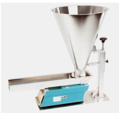
شکل (۱-۱۱) : دستگاه انتقال ذرات کوچک ورودی از نازل [۵]
