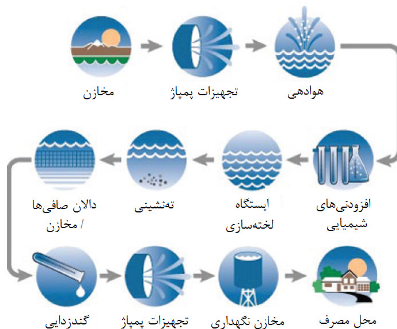
شکل ۱-۱: مراحل تصفیه آب به روش سنتی
