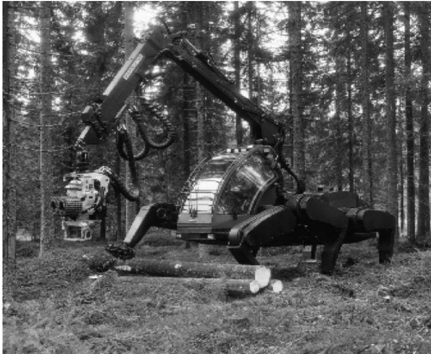
شکل (۱-۱)- اولین ربات موبایل طراحی شده توسط پلاستچ [۲۰]
