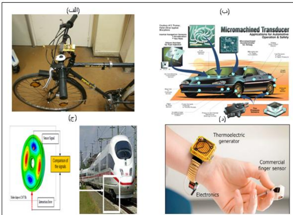
شکل ۳-۱: (الف) ژنراتور پیزو الکتریک برای تامین توان لامپ [۶]. (ب) میکرو ژنراتور بکار رفته در خودرو [۷]. (ج) تولید توان از چرخ قطار شهری [۸-۹]. (د) تولید توان از انگشت شصت [۱۰].
