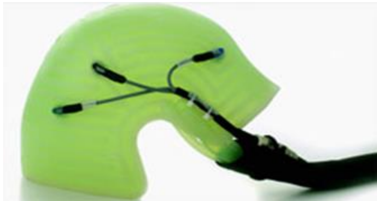
شکل ۱-۶ سنسورهای به کار رفته داخل کلاهک سرد کننده حاوی سیال سرد
