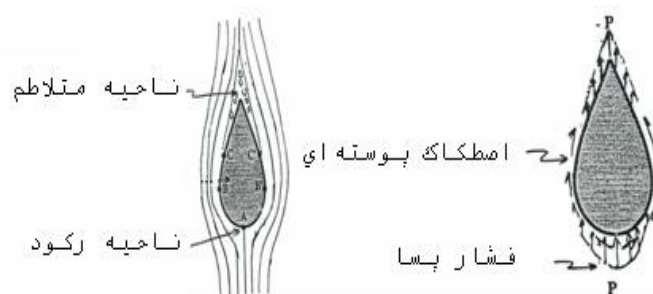
شکل ۲-۳- نیروهای اعمالی به یک دانه ذرت در مسیر جریان باد [۴۸].
