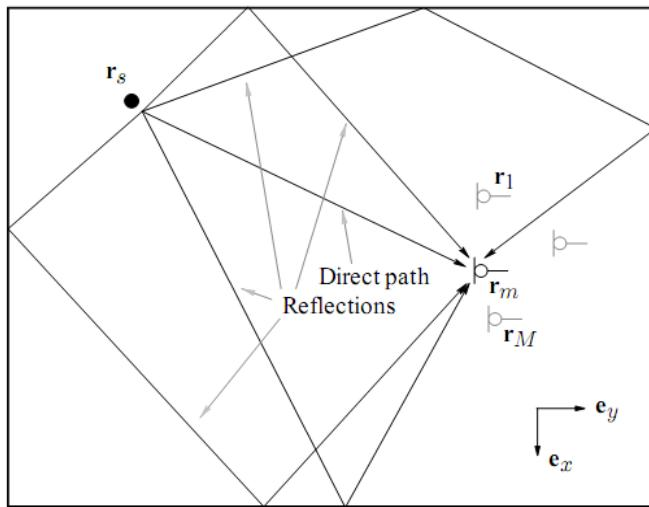
شکل (۱-۱): مسیرهای سیگنال صوتی برای یک میکروفون خاص در صفحه  $x-y$ .  $r_s$  و  $r_m$  به ترتیب نشان دهنده محل منبع و میکروفون  $m$ -ام می‌باشد. هر مسیر از منبع تا میکروفون  $m$ -ام می‌تواند با یک میرایی و تاخیر از سیگنال منبع نمایش داده شود. مسیر مستقیم دارای کمترین تاخیر می‌باشد. با در نظر گرفتن مجموع همه مسیرها، می‌توان پاسخ ضربه اتاق برای منبع مشخص و مکان میکروفون را اندازه گرفت.
