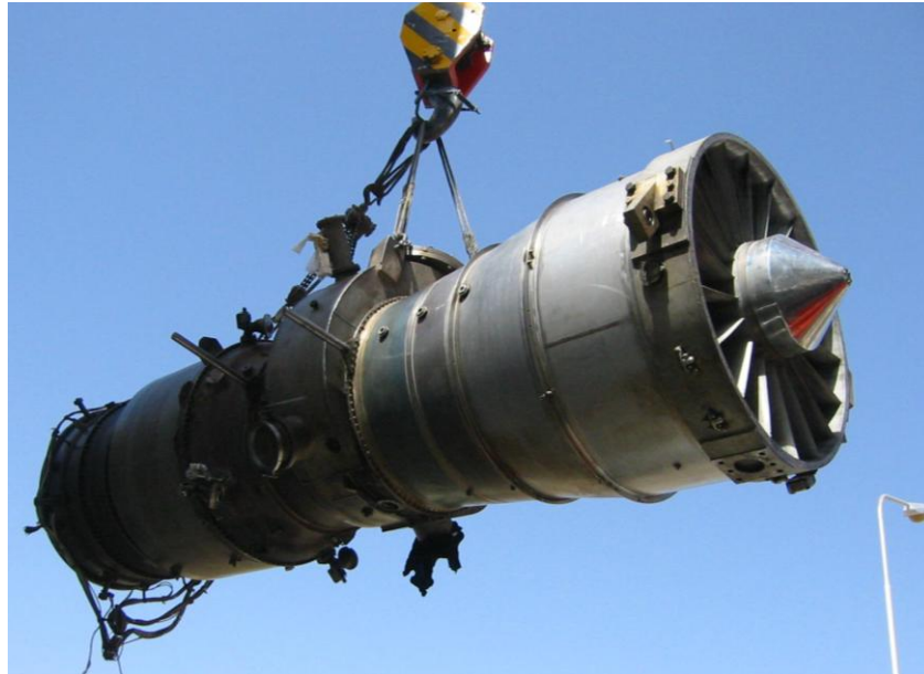
شکل ۱-۹-الف تصویر واقعی توربین گازی نیروگاه هسا شامل بخشهای ژنراتور و توربین آزاد
