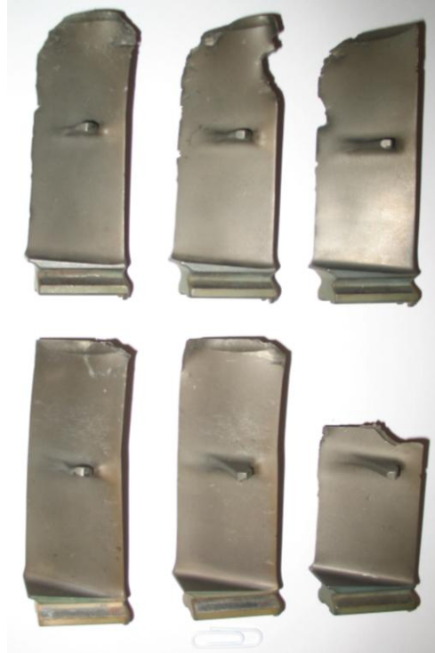
شکل ۱۳-۱ پره های تخریب شده ردیف نهم کمپرسور HP در شکست دوم.
