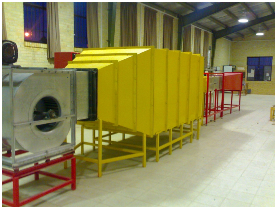
شکل (۱-۳): نمایی از تونل باد استفاده شده در این تحقیق
