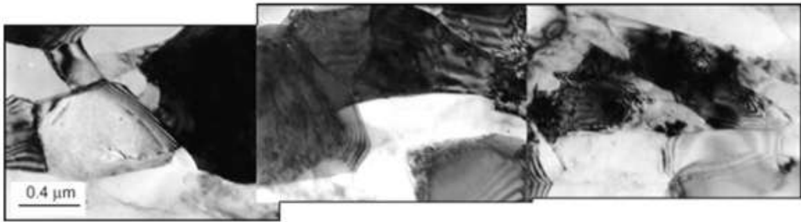
شکل ۱-۲: ساختار UFG آلیاژ Al 1070 بعد از SPD (کرنش ۶/۹) [۷]
