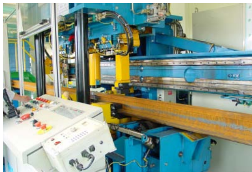
شکل (۲-۱۲) - دستگاه تنظیم کننده راستای طولی ریل ها پیش از انجام عملیات جوشکاری برقی [۴]
