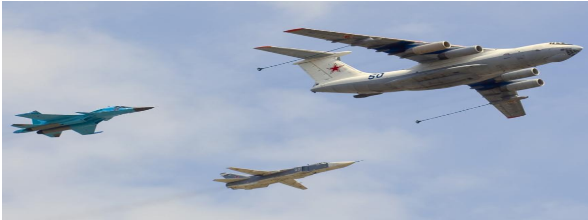
شکل ۱-۲ هواپیماهای شکاری در حال سوخت گیری یکی از مشکل ترین مانورهای هواپیماهای شکاری که نیاز به دقت فراوان خلبان دارد [۱۱]
