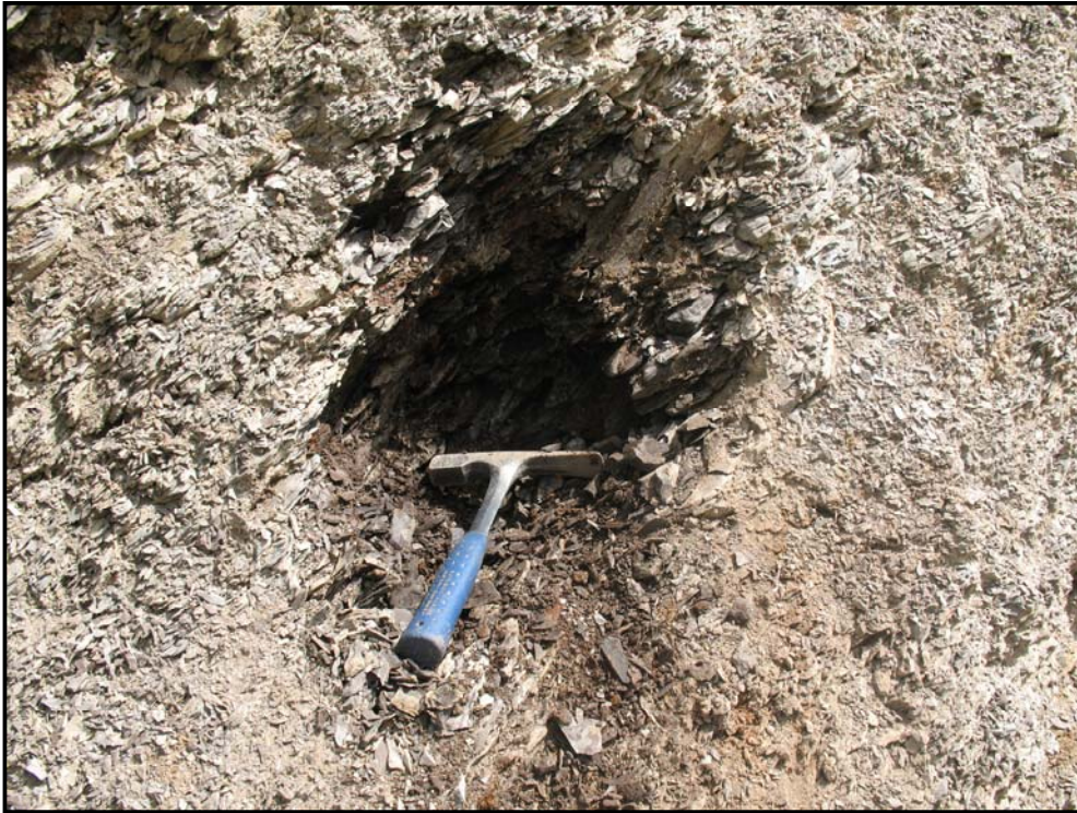
شکل (۱-۱) نحوه نمونه برداری از شیل‌های کژدمی به منظور مطالعات آزمایشگاهی
