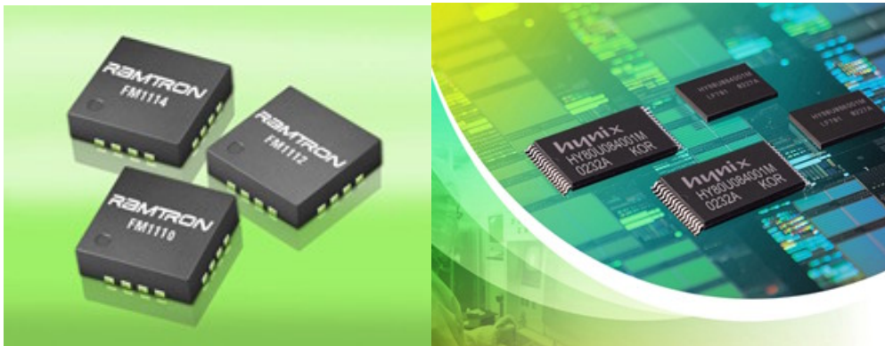
شکل (۷-۱): حافظه فروالکتريکی با دسترسی تصادفی غیر فرار (FRAM)
