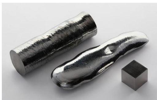
شکل ۲-۱ رنیم فلزی، وزن یک مکعب رنیمی با ابعاد ۱۰cm معادل ۲۱ کیلوگرم است (wikipedia).
