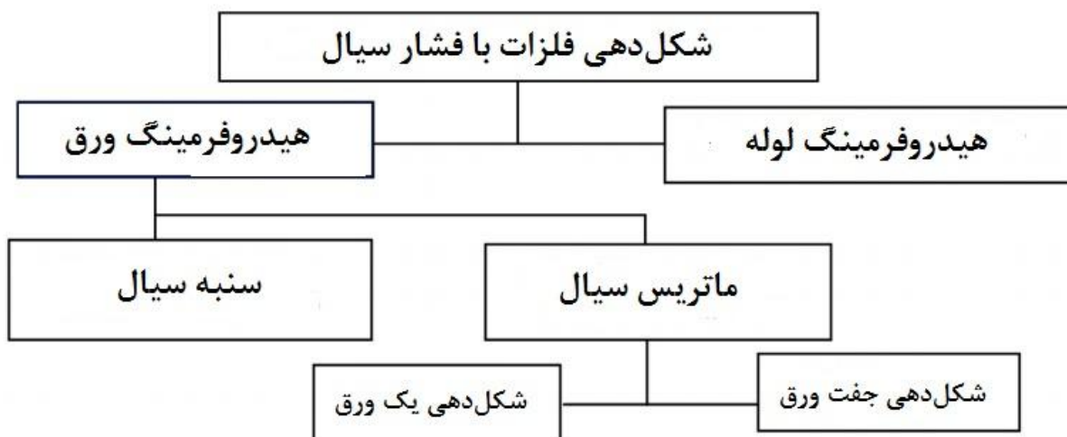
شکل (۱-۱) دسته‌بندی فرآیند هیدروفرمینگ از نظر شکل اولیه [۷]
