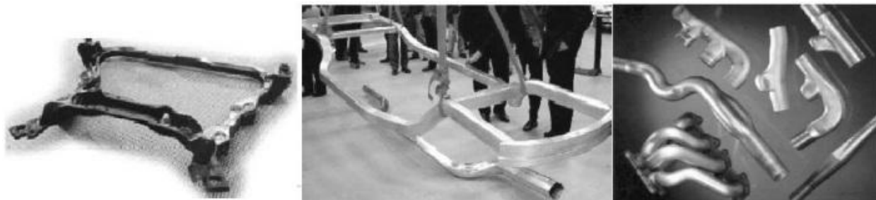
شکل (۱-۳) نمونه‌هایی از قطعات تولید شده با استفاده از فرآیند هیدروفرمینگ لوله [۶]
