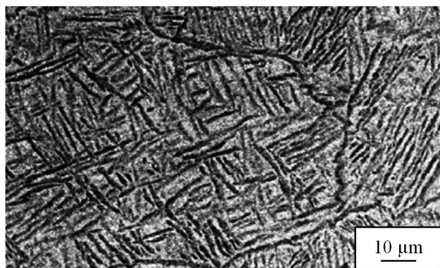
شکل ۲-۳- تصویر SEM از آلیاژ Ti-10V-4.5Fe-1.5Al پس از پیرسازی [۲].
