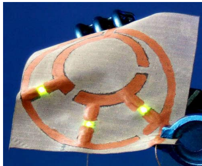
شکل 1-2 نمونه ای از چاپ هادی بر سطح پارچه که اتصال مابین باتری و لامپهای کوچک را برقرار نموده است.
