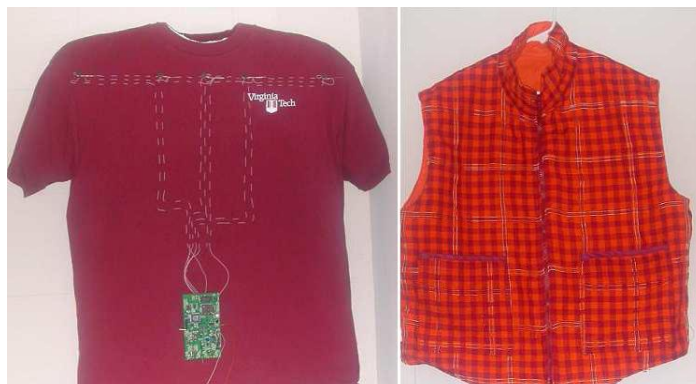
شکل 3-1 نمونه‌هایی از دوخت هادی بر روی پارچه [10]
