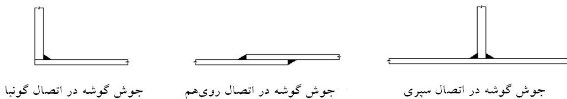
شکل (۱-۴) - انواع جوش گوشه در اتصالاتها
