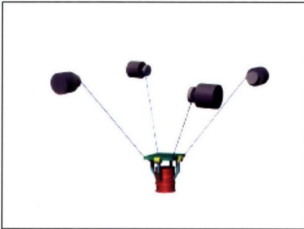
شکل ۱-۱ ربات کابلی معلق با ۴ موتور [6]
