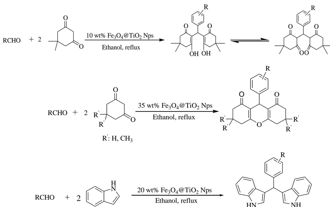
کلید واژه: نانوذرات مغناطیسی  $\text{Fe}_3\text{O}_4@/\text{TiO}_2$ ، تتراکتون، ۸،۱-دی اکساییدروزانتن و بیس ایندولیل متان
