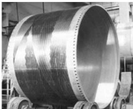
شکل ۱-۷: سازه‌ی مشبک با هسته‌ی فومی و پوسته در دو طرف
