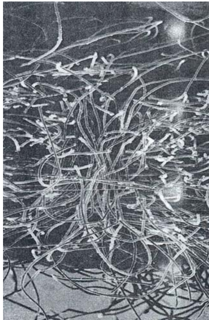
شکل ۱-۱۶ تصویر سطح مقطع لایه (تغییر آرایش الیافی و جا به جایی الیاف) [۱۳]
